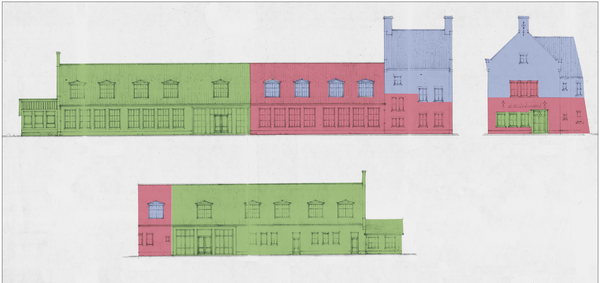
De bouwfaserings van de Willibrordusschool ingekleurd op de geveltekeningen van de straatzijden (boven) en de achterzijde (onder).
